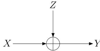
Das Eingangssignal  $X$  sei mittelwertfrei. Der additive Rauschterm ist normalverteilt mit  $Z \sim N(0, \sigma^2)$  und stochastisch unabhängig von  $X$ . Ferner unterliege das Ausgangssignal  $Y$  einer Leistungsbeschränkung  $E(Y^2) \leq L$ ,  $L > \sigma^2$ . Bestimmen Sie die Kapazität des Kanals.
